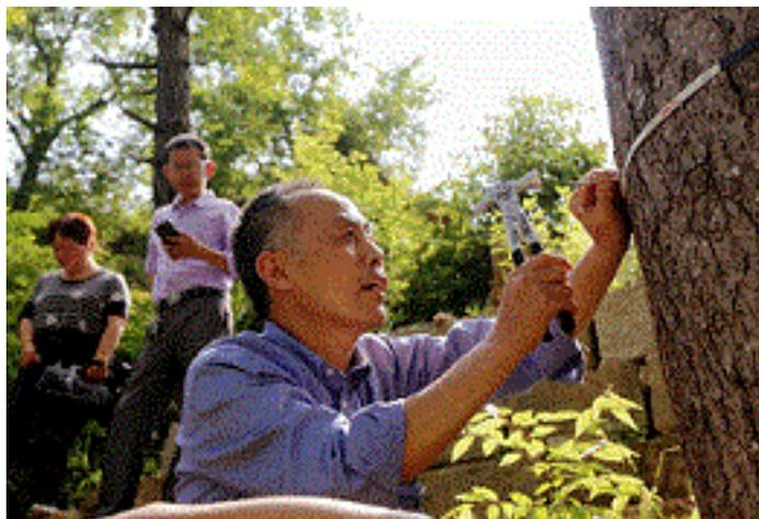
4. 用 ARBOTOM 应力波树木缺陷检测仪测定树干：
