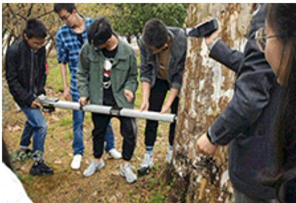
IML-RESI PD 系列木质检测仪可以用于任何可靠稳定的木质检测实验中。通过实时测量探针的钻探阻力，从而检测树木内部腐烂情况、空洞情况和虫蛀情况等。可应用于以下方面：
