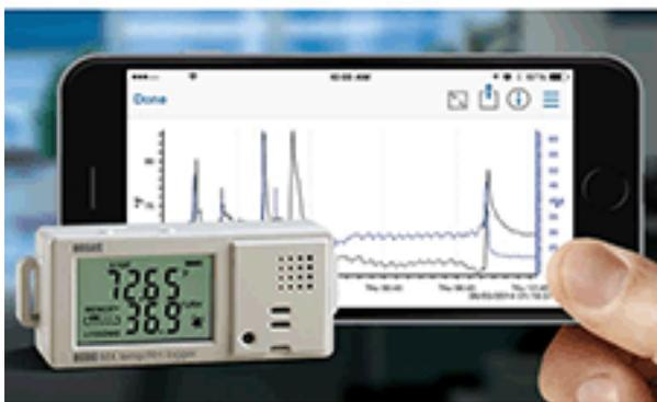
“MX1101 记录仪让我们可以了解我们之前没有的整个结构； 我们可以监控整个建筑内的各个空间，有助于更好地保护博物馆收藏的不可替代的音乐文物，”马可尼说。“蓝牙功能特别有用，因为许多记录仪位于难以触及的位置 - 例如展示柜的顶部或内部，或隐藏在仪器的后面和下面。”
