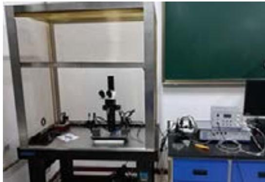
SSR 昆虫触角单感器测量系统
