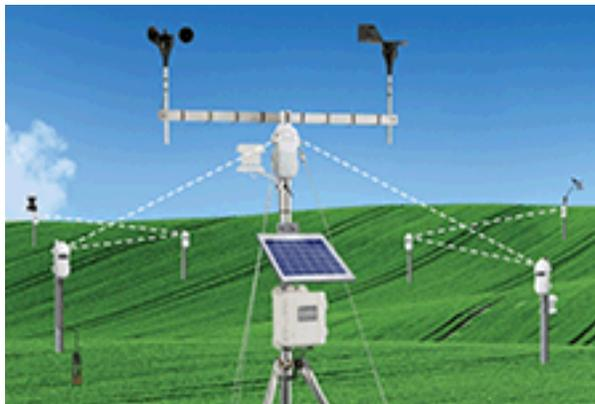
经济高效的 HOBOnet 现场监控系统包括捕获近实时室外或温室数据所需的一切。HOBOnet 基于经过现场验证的 HOBOnet®RX3000 远程监控站和功能强大的基于云的 HOBOnet™ 软件，可用于远程系统管理，具有一套新的无线传感器，可覆盖各种户外测量。该系统将网状网络中的 RX3000 和多达 50 个无线传感器连接起来，以便测量曾经被认为成本太高或监测不切实际的大面积区域。HOBOnet 现场监控系统可通过任何网络浏览器访问数据，无论是在台式机，笔记本电脑还是移动设备上，因此种植者和研究人员可以随时随地获得及时的信息。
