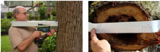
IML-RESIF 系列木质检测仪对活力木进行健康状态检测
